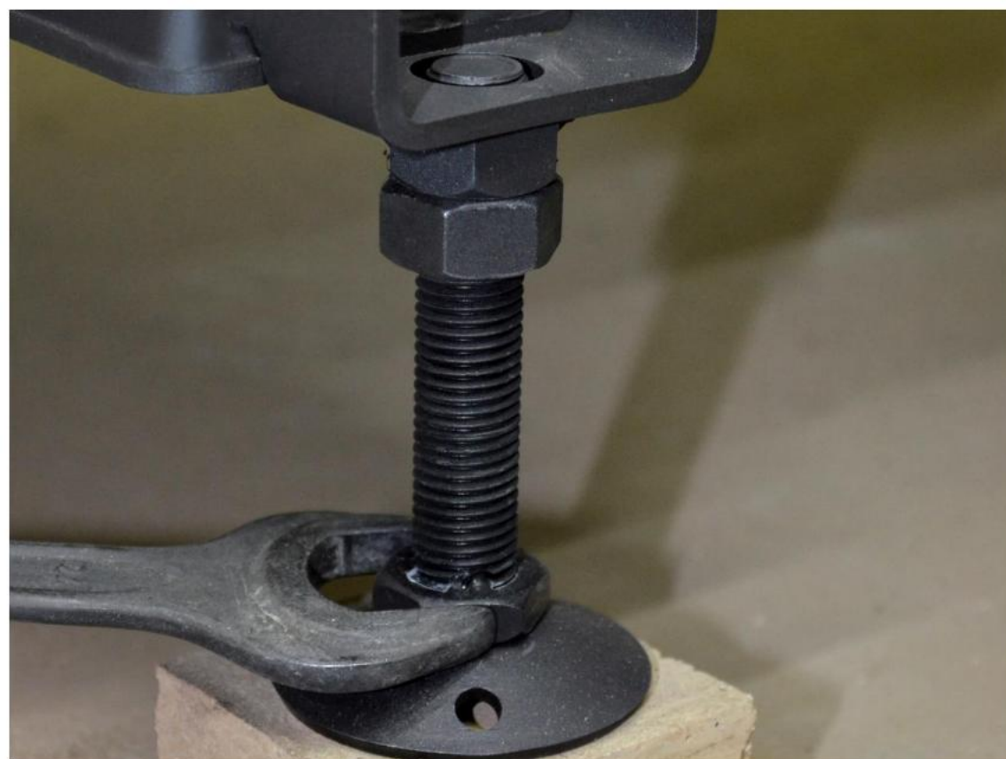
30) Magasságállítás állítható csavarokkal.
